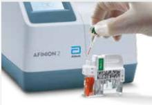
Insérer la cassette de dosage dans l'analyseur et fermer le tiroir. L'analyse démarre automatiquement.
