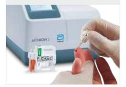
Replacer le dispositif d'échantillonnage dans la cassette de dosage.
