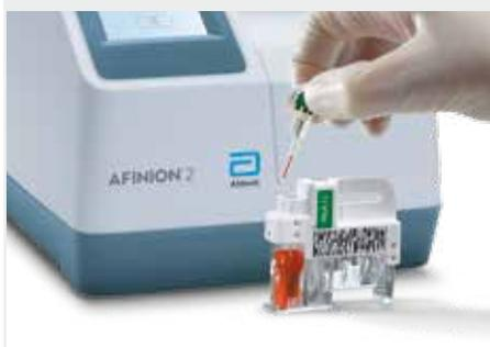
**3** Insérer la cassette de dosage dans l'analyseur et fermer le tiroir. L'analyse démarre automatiquement.
