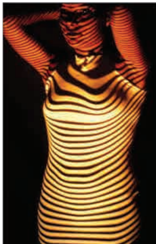
Figure 19 : prise d'empreinte optique par projection de franges colorées avec le système ORTEN®.
